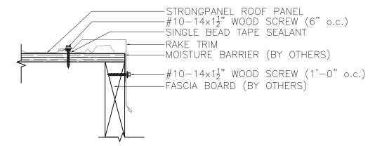
STRONGPANEL RAKEWALL DETAIL
