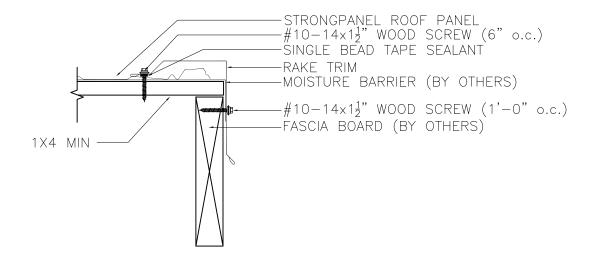
STRONGPANEL RAKEWALL DETAIL
